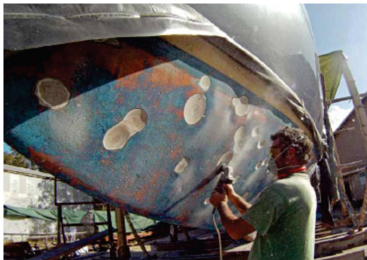
Estrutura do casco sofre degradação gradual
